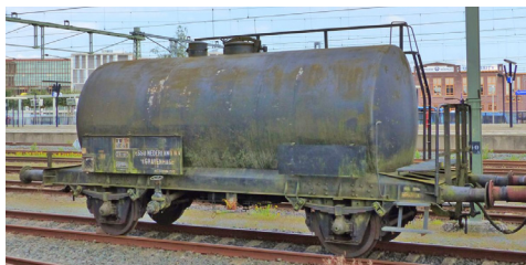
De tweeassige ketelwagen type Uh met nummer NS 21 84 070 3 204-2 oorspronkelijk eigendom van Esso Nederland en nu van de VSM (Veluwsche Stoomtrein Maatschappij), Apeldoorn 01-09-2017
